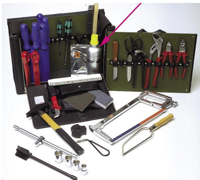
Pilt 3. Kaablimontööri tööriistakomplekti näidis. Pildil näitab nool metallist puhastusvahendi pudelit (piirituse või bensiini jaoks)
