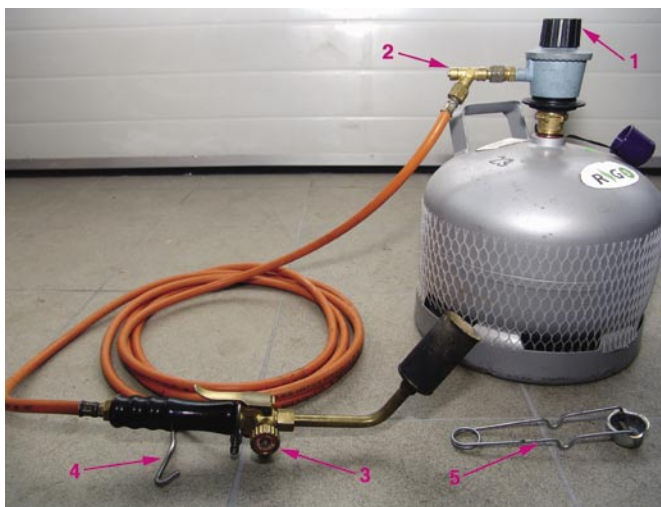
Pilt 1. Gaasipõleti komplekti näidis: 1 gaasikraan, 2 tagasilöögiklapp, 3 gaasi väljavoolu regulaator, 4 harktugi, 5 gaasipõleti süütamise seade
