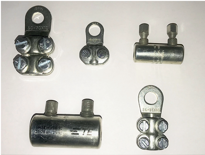
Pilt 4. Mehaanilised kaablikingad ja jätkuklemmid keskpingekaablite ekraanitraatidele. Kahte alumist klemmi saab kasutada AHXAMK-W kaabli kesksjuhtme jaoks
