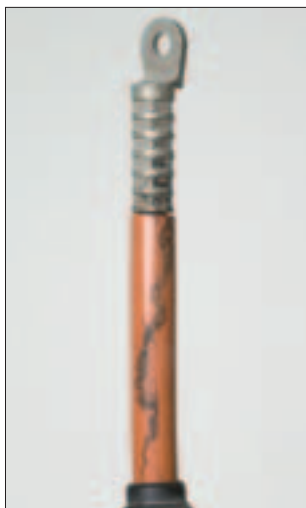
Образец, поврежденный трекинговой дорожкой
