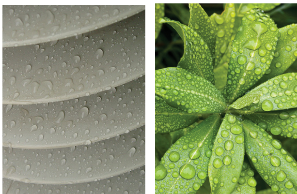
Pilt 4. Vihmapiisad kogunevad polümeerisolaatoritele üksikute mullikestena, samamoodi nagu enamustele taimedele.
