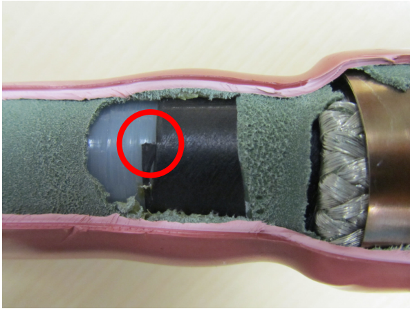
Pilt 7. Selline koorimisel jäetud terav lõikeserv (pügal) võib osutuda ohuallikaks.
