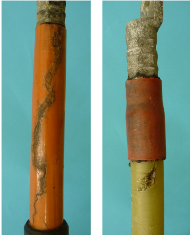
Pilt 5. Roomavlahenduse näide (vasakul) ja erosiooni näide kaablis (paremal).
