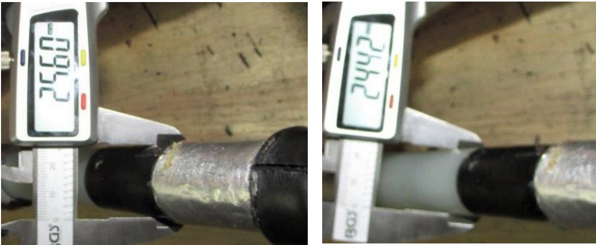
Pilt 5. Näide 1: Peale koorimist oli isolatsioonikihi diameeter 24,42 mm.
