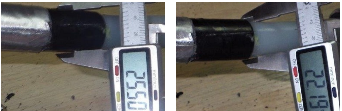
Pilt 6. Näide 2: Peale koorimist oli isolatsioonikihi diameeter 22,19 mm.
