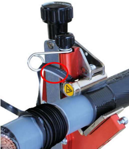
Pilt 2. Kooritud lindi peal oleva musta kihi osa on umbes 70-80% ja valge isolatsioonikihi osa umbes 20-30%.
