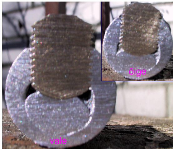
Pilt 4. Jätkuklemmi, mille kasutusvahemik on 70-120 mm², oli paigaldatud 150 mm² soon. Klemmi seest liigselt väljaulatuv poldiots põhjustas läbilöögi.
