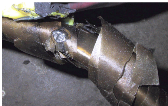
Pilt 5. Painutamise tõttu purunenud paberikihid ja selle keskel läbilöögiikoht.
