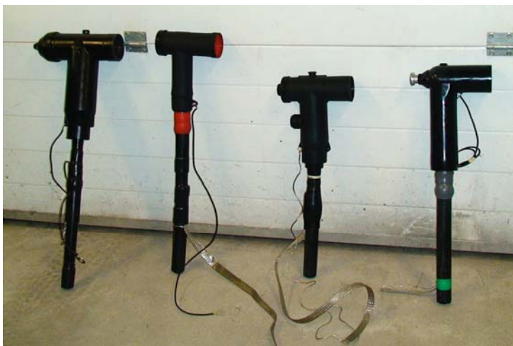
Pilt 6. Töö on valmis – pildil on nelja erineva tootja 20kV ekraneeritud nurkliited.
