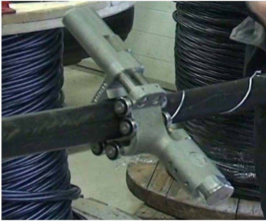
Pilt 2. Euromoldi toote paigaldamisel eemaldati kaabli välistest koos fooliumkihiga kasutades selleks pildil olevat tööriista.
