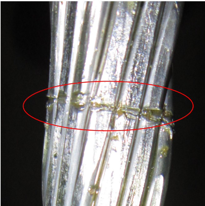
Pilt 4. Kaabli alumiiniumsoon on rikutud.
