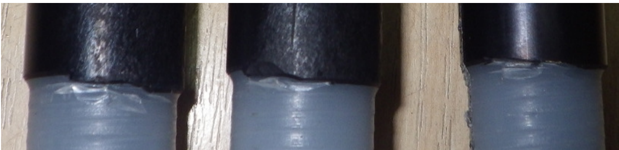
Pilt 3. Kaabli pooljuhtkihi ja isolatsioonipinna vaheline üleminekuserv on rikutud.
